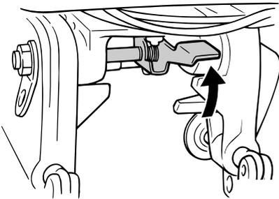
2. Lleve hacia arriba el gatillo de bloqueo en punto muerto (si está instalado) y desplace rápida y firmemente la palanca de control remoto desde punto muerto a marcha atrás.
