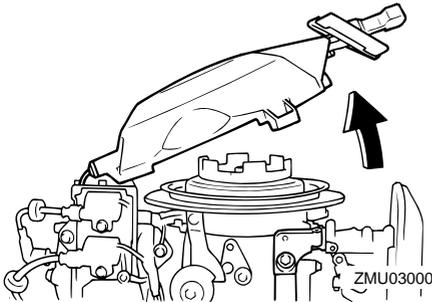
4. Prepare el motor para arrancarlo. Para más información, vea la página 21. Compruebe que el motor se encuentra en punto muerto y que la placa de bloqueo del cable del interruptor de parada del motor está fija a ese interruptor. El interruptor principal debe estar en la posición "ON" (activado), si está instalado.
