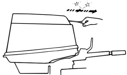
6. Después de arrancar el motor, vuelva lentamente el tirador de arranque manual a su posición original antes de soltarlo.
