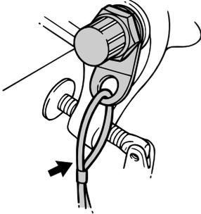
3. Asegure el soporte de fijación al peto de popa utilizando los pernos suministrados con el motor fueraborda (si se incluyen). Para detalles, consulte a su concesionario Powertec.
