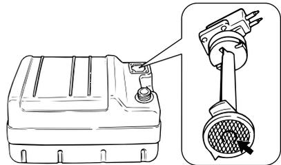
4. Limpie el filtro (situado en el extremo del tubo de aspiración) con un disolvente de limpieza apropiado. Deje secar el filtro.
