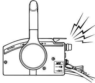
Si se hubiera activado el sistema de alarma, pare el motor y compruebe la entrada del agua de refrigeración para ver si está obstruida.
