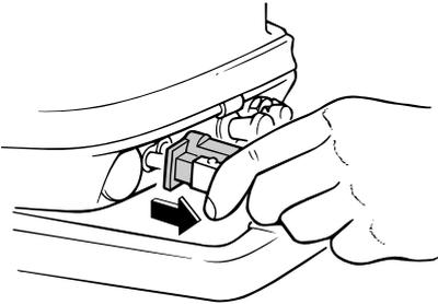
3. Ponga la palanca de bloqueo de la elevación (si está instalada) en la posición de liberación/elevada.
