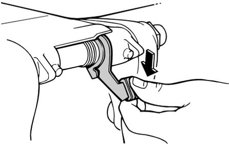
3. Eleve ligeramente el motor fueraborda y tire de la palanca para navegar en aguas poco profundas hacia el peto de popa.
