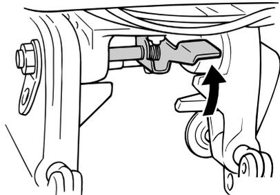
3. Desplace rápida y firmemente la palanca de cambio de marcha de punto muerto a marcha atrás.
