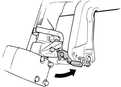
5. Sujete con una mano la parte posterior de la capota superior y levante totalmente el motor.
