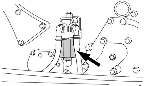
2. Desenrosque la taza del filtro, recogiendo con un trapo el combustible que se derrame.
