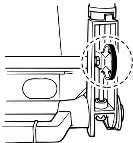
Cuando desee una velocidad constante, apriete el regulador para mantener el ajuste del acelerador deseado.
