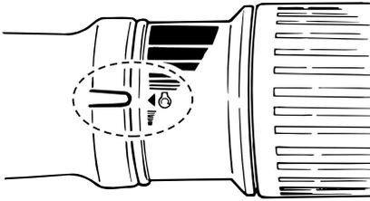
4. Saque / gire completamente el tirador del estrangulador. Después de arrancar el motor, sustituya / vuelva a poner el tirador en la posición inicial.
