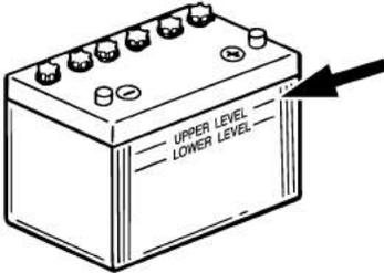
2. Mantenga siempre la batería en buen estado de carga. La instalación de un voltímetro le ayudará a controlar su batería. Si no utiliza el barco durante uno o más meses, extraiga la batería del barco y almacénela en un lugar frío y oscuro. Recargue completamente la batería antes de utilizarla.
