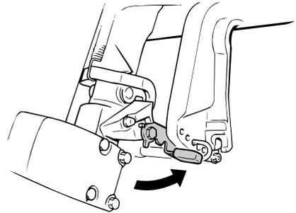
4. Para reintegrar el motor fueraborda a la posición normal, ponga la palanca de cambio de marcha en punto muerto y, a continuación, eleve ligeramente el motor fueraborda. Baje la palanca para navegar en aguas poco profundas. Ponga la palanca de bloqueo de la elevación en la posición de bloqueo y baje despacio el motor fueraborda.
