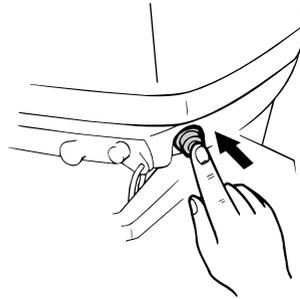
6. Inmediatamente después del arranque del motor, suelte el botón de arranque y deje que vuelva a su posición original.
