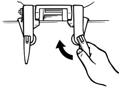
2. Si su motor está equipado con un gancho del cable de seguridad, debe utilizarse un cable o cadena de seguridad del motor. Fije un extremo al gancho del cable de seguridad del motor y el otro a un punto seguro de montaje en el barco.
