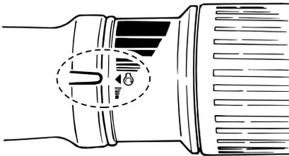
4. Saque / gire completamente el tirador del estrangulador. Después de arrancar el motor, sustituya / vuelva a poner el ti-
