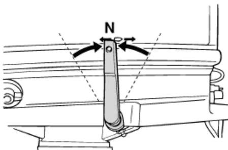
2. Inclíne el motor fueraborda ligeramente hacia arriba hasta que la barra de soporte de la inclinación gire automáticamente a la posición de bloqueo para sujetar el motor. El motor fueraborda está equipado con 2 o 3 posiciones para la navegación en aguas poco profundas.
