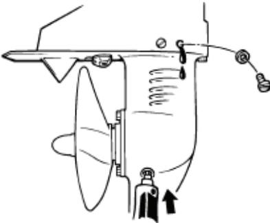
6. Coloque una junta nueva en el tapón de comprobación del nivel de aceite. Cuando el aceite empiece a fluir del orificio del tapón de comprobación del nivel de aceite, introduzca el tapón y apriételo.
