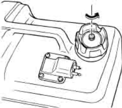
2. Si el motor dispone de un conector de combustible, conecte el tubo de combustible firmemente al conector. A continuación, conecte firmemente el otro extremo del tubo de combustible al conector del depósito de combustible.
