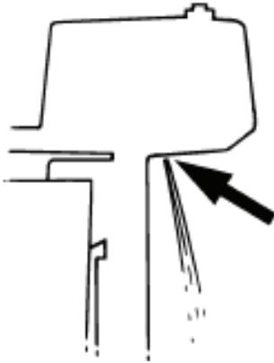
Compruebe que no haya fugas de agua por las uniones entre la tapa del escape, la culata y el cilindro.
