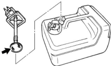
4. Limpie el filtro (situado en el extremo del tubo de aspiración) con un disolvente de limpieza apropiado. Deje secar el filtro.
