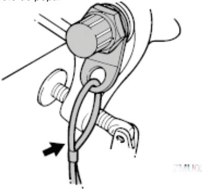
3. Asegure el soporte de fijación al peto de popa utilizando los pernos suministrados con el motor fueraborda (si se incluyen). Para detalles, consulte a su concesionario PowerTec Outboards. **¡ADVERTENCIA!**
