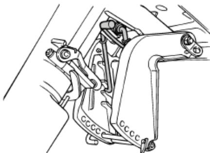
3. Para bajar el motor fueraborda a la posición de funcionamiento normal, en primer lugar inclínelo ligeramente hacia arriba. A continuación, tire hacia arriba de la palanca de la barra de soporte de la inclinación e incline el motor lentamente hacia abajo.
