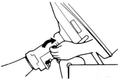
3. Si está instalada la varilla de soporte del motor elevado: Tire de la varilla hacia fuera e incline el motor fueraborda lentamente hacia abajo.
