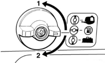
1. Posición "ABIERTO" para el depósito integrado
