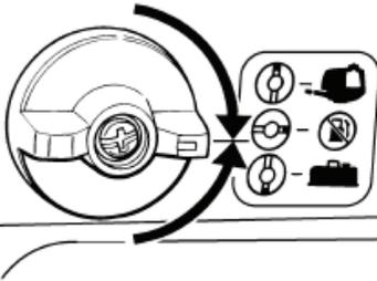
3. Desconecte el tubo de combustible si está utilizando un depósito de combustible exterior.
